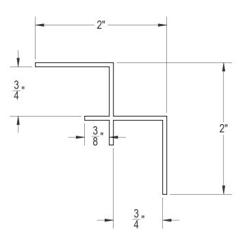
MATERIAL: ALUMINUM EXTRUSION 6063-T3 FINISH: POWDER COATED
